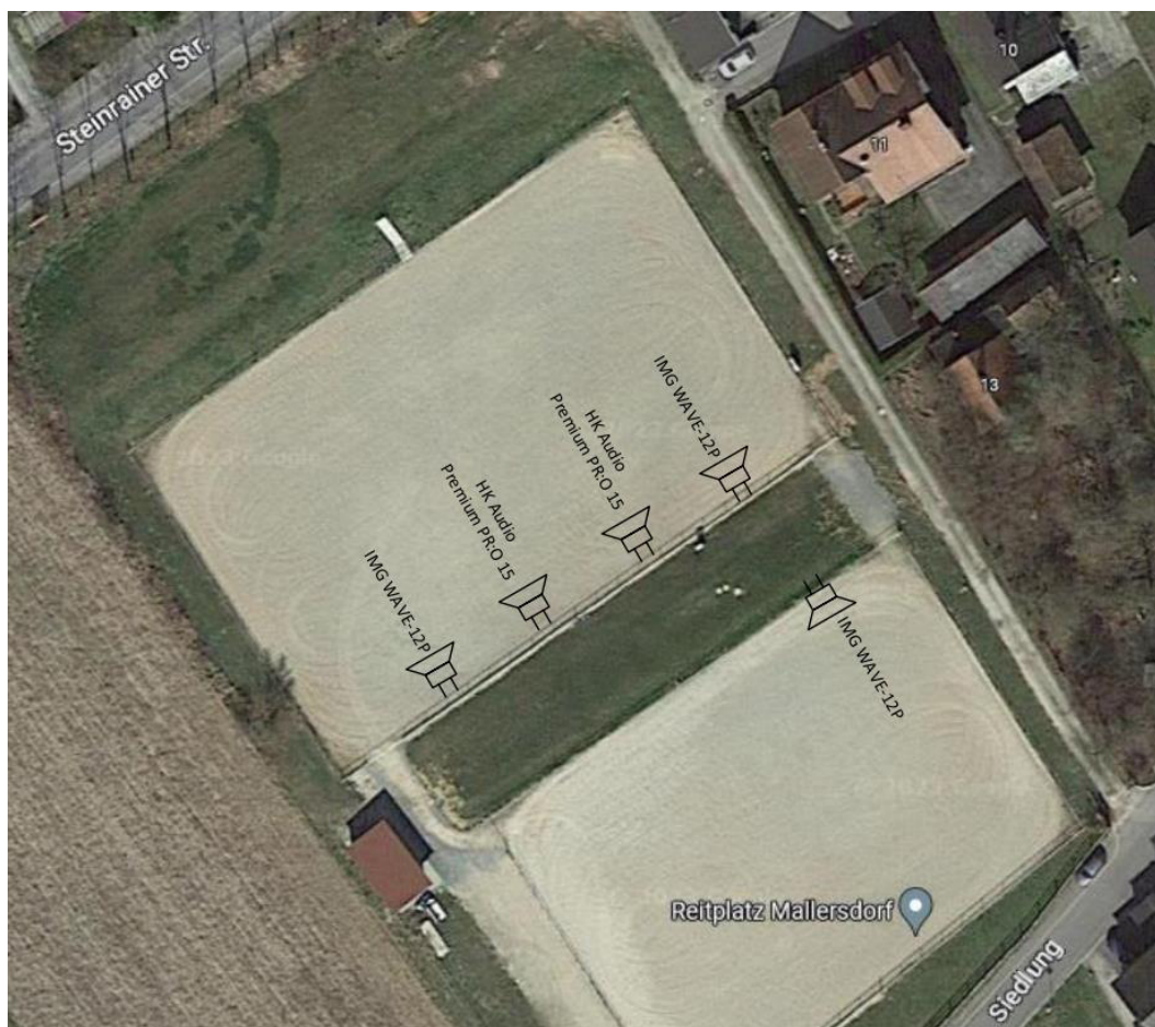
Abbildung 2: Lageplan Beschallungsanlage für Turniere
