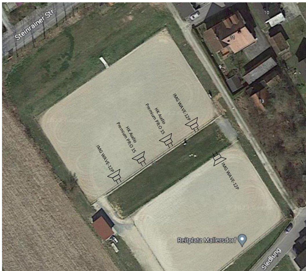
Abbildung 2: Lageplan Beschallungsanlage für Turniere
